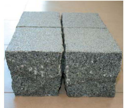
Granito trinkelės paviršius gali būti pjautas, degintas, apdirbtas dantytkūju (bučerduotas)
